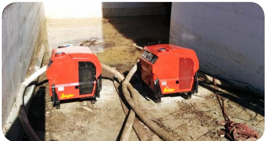
Über 2.000 Liter je Minute pumpt jede der beiden Tragkraftspritzen.
