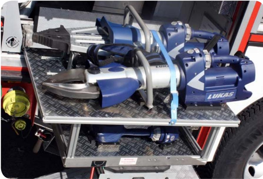
Einbau des Rettungssatzes auf einem Auszug im Hilfeleistungslöschfahrzeug.
