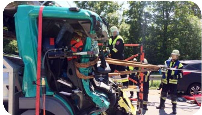
Die A-Säulen sind geschnitten, die Front an der Winde angehängt, um sie nach vorne zu ziehen.
