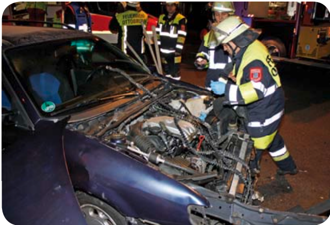
Am Unfallfahrzeug wird die Batterie abgeklemmt.
