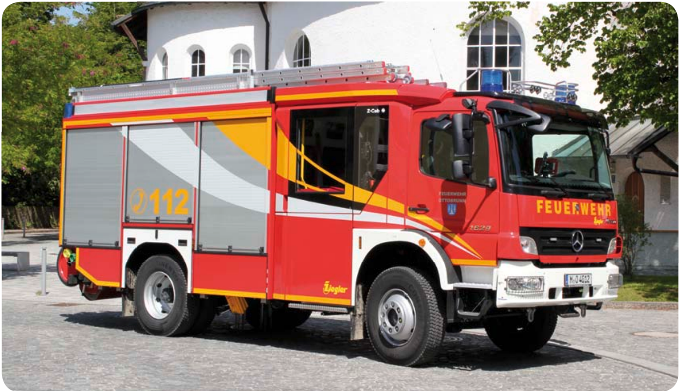
Das modernste Löschfahrzeug der Ottobrunner Feuerwehr bringt neun Einsatzkräfte, 2000 Liter Wasser und viele Geräte an die Einsatzstelle.
