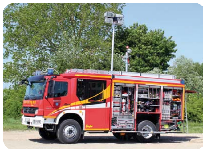
Ein Lichtmast und ein Wasserwerfer befinden sich auf dem Dach.
