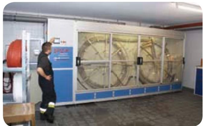
Die neue, automatische Schlauchpflegeanlage erspart viel Arbeit und verringert den Personalbedarf zur Bedienung.
