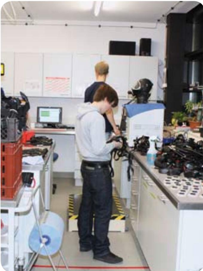
Die Reinigung und Prüfung der Atemschutzmasken nach einem Großbrand ist eine zeitaufwändige Arbeit, die sehr sorgfältig durchgeführt werden muss.
