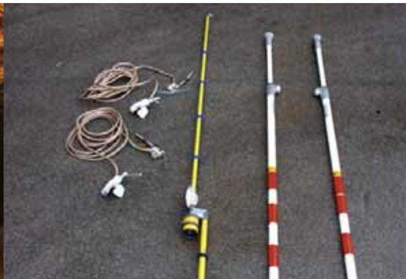
Der Gerätesatz Bahnerdung besteht aus einem Spannungsprüfer, zwei Erdungsstangen und zwei Erdungslitzen mit angebrachter Fahrdrabt- und Schienenklemme.
