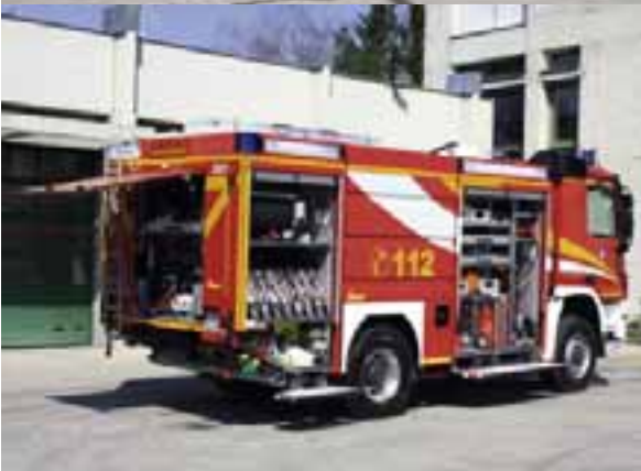
Das TLF 24/50 dient zum Transport von Löschmitteln mit hoher Pumpenleistung.
