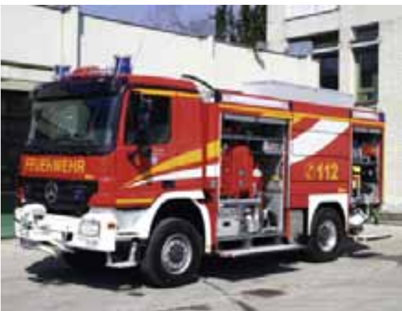
HLF 20/16, ausgelegt für technische Hilfeleistung und Brandbekämpfung.
