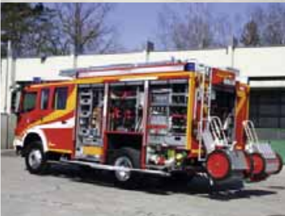
HLF 20/16, ausgelegt für technische Hilfeleistung und Brandbekämpfung.
