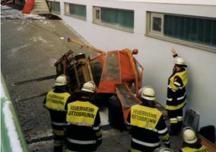
Der Stapler wurde gesichert und vorsichtig mit Seilwinde und Hebekissen wieder auf seine vier Räder gestellt.
