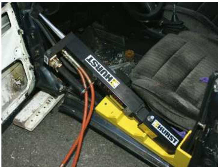
Mit dem Rettungszylinder lässt sich der Vorderwagen nach vorne kippen. So können eingeklemmte Personen schonender befreit werden.
