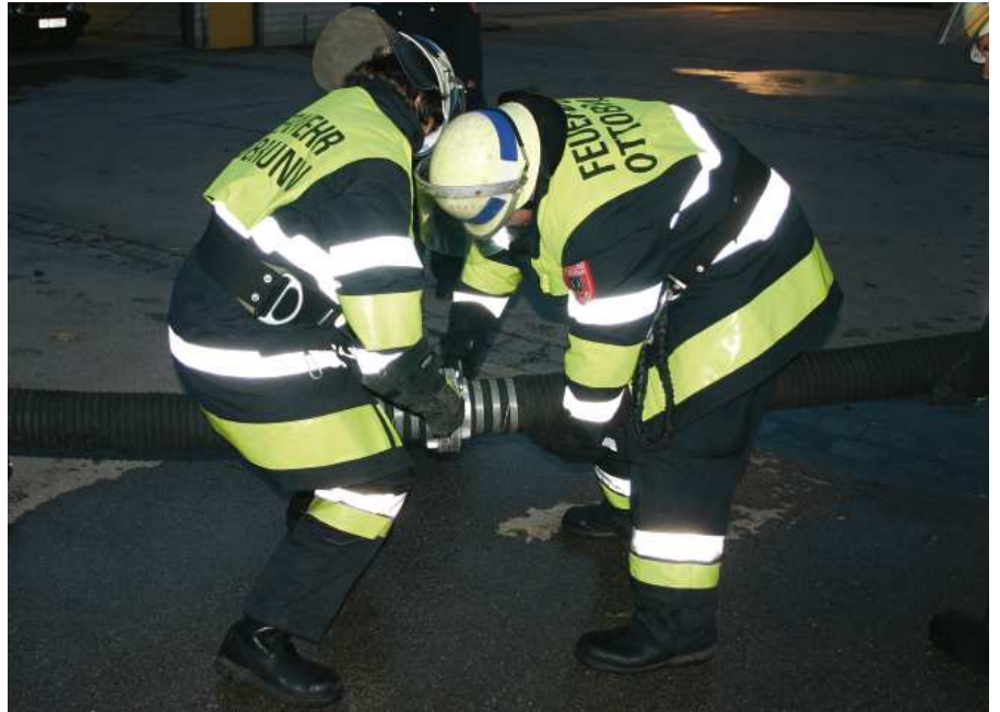
90 Sekunden - länger darf das Kuppeln der Saugleitung nicht dauern!
