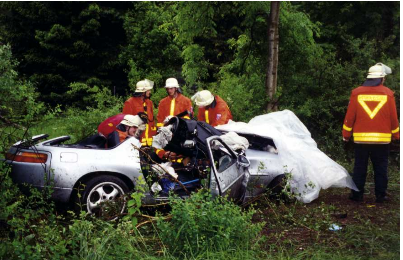
Das Dach des Porsches wurde mit Spreizer und Schere abgetrennt, so konnte der Fahrer schonend und ohne weitere Verletzungen aus dem Fahrzeug befreit werden.
