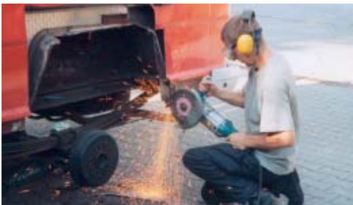
Die verrosteten Blechteile müssen raus.
