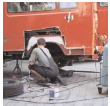
Der neue Radlauf wird eingepasst.
