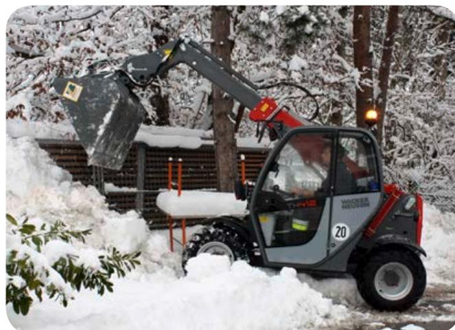
Der Teleskoplader kommt das ganze Jahr über zum Einsatz. Dafür stehen Kehrmaschine, Schneeschlepper, Streuer und Schaufel zur Verfügung.
