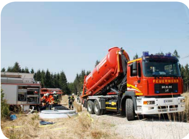
08.04.2017: Je Fahrt brachte der Wechsellader 10.000 Liter Wasser zur Einsatzstelle. Er leerte diese in zwei Fallbecken, aus denen die Löschfahrzeuge ihr Wasser bezogen.
