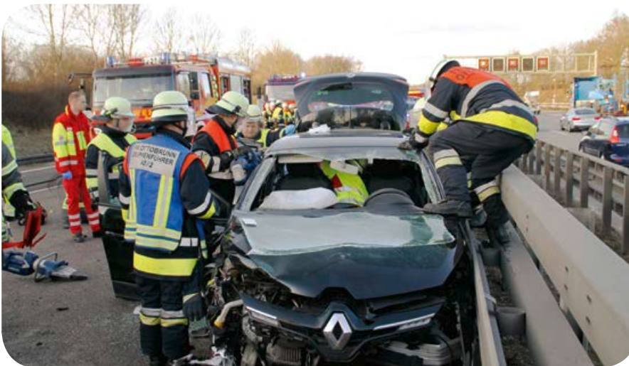
03.03.17: Mit der akkubetriebenen Rettungsschere wird auf der rechten Fahrzeugseite der B-Holm durchgetrennt.
