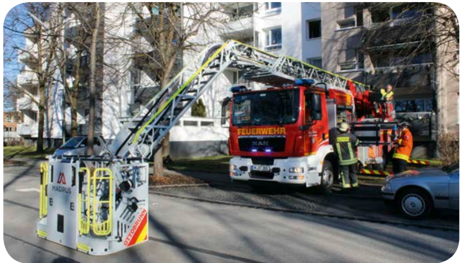
24.12.17: Bei der neuen Drehleiter lässt sich der Korb vor dem Fahrzeug absenken. So können die Kameraden die Krankentragenhalterung, die sie gerade aus dem Gerätefach entnehmen, bequem montieren.
