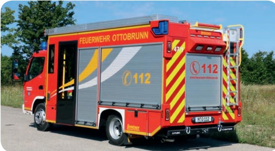
Die reflektierende gelb-weiße Beklebung auf den Seiten und die Streifen am Heck erhöhen die Warnwirkung im Straßenverkehr.
