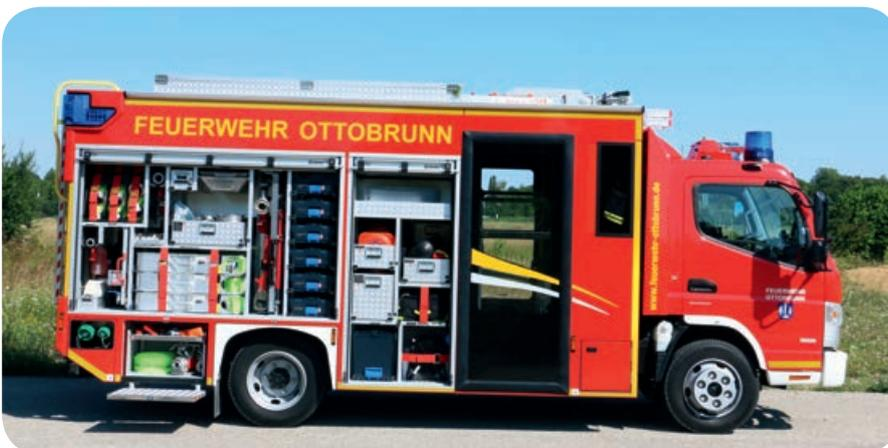
Auf der rechten Seite liegen im vorderen Geräteraum Verkehrswarngerät, Türöffnungsrucksack, zwei Pressluftatmer, leichte Chemikalienschutzanzüge, Kabeltrommel und Handkreissäge. Im hinteren Geräteraum Hygienebord, B-Schlauchtragekörbe, wasserführende Armaturen, und Mittelschaumpistole. Im Regal sind Werkzeugkästen. Im Traversenkasten liegen C-Schnellangriffsleitung und Verteiler mit B-Schlauch.
