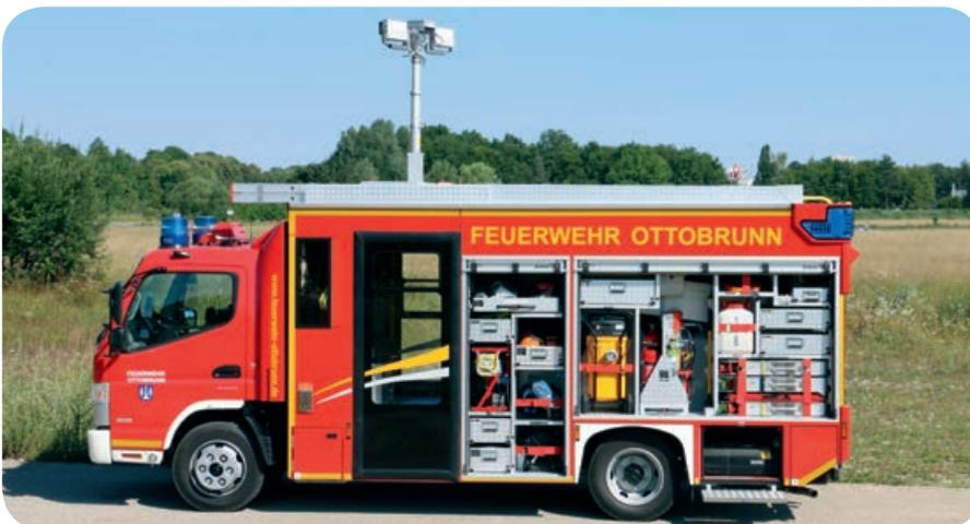
Auf der linken Seite sind unter anderem im vorderen Geräteraum Hochleistungslüfter, Kettensäge, Hochentaster, Kombispreizer, Rüstholz, Sichtschutzwand, Tauchpumpe und Kabeltrommel verstaut. Im hinteren Geräteraum finden sich Wassersauger, Feuerlöscher, Rettungsbrett, C-Schlauch-tragekörbe mit Rauchschutzvorhang und Ölbinder.
