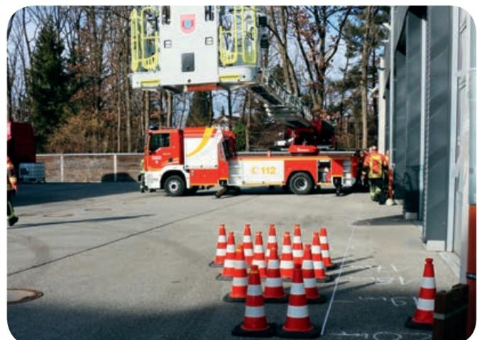
Die Verkehrsleitkegel und die Zahlen am Boden zeigen an, was unserer Leiter leistet: 20 Meter mit zwei Einsatzkräften
