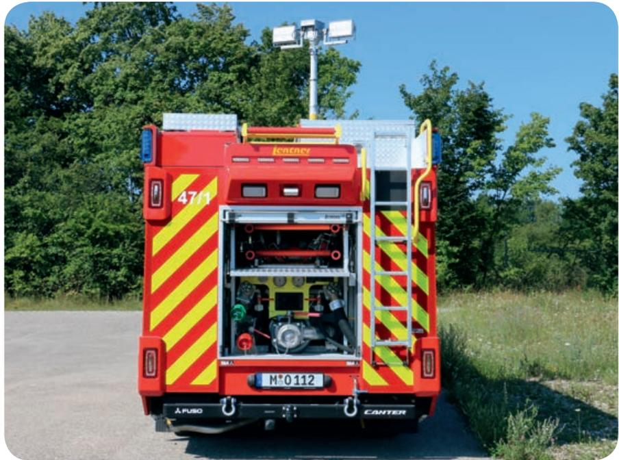
Oberhalb des Pumpenbedienstandes ist das Fach geöffnet für das zusammengelegte Lkw-Rettungsgerüst. Auf dem Dach ist der Lichtmast aufgeklappt und ein Stück weit ausgefahren. Oben lagern vier Steckleiterteile, Saugschläuche, Schlauchbrücken, Ölbinde und Bahnerdungsgarnitur.
