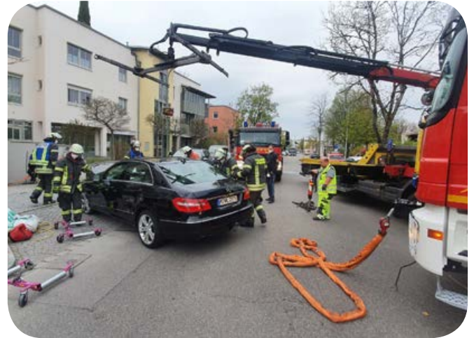
Mit der Winde des Wechselladers zog die Feuerwehr zwei beschädigte Pkw aus der Tiefgarage. Diese hatte man zuvor auf die Fahrzeugroller gesetzt.
