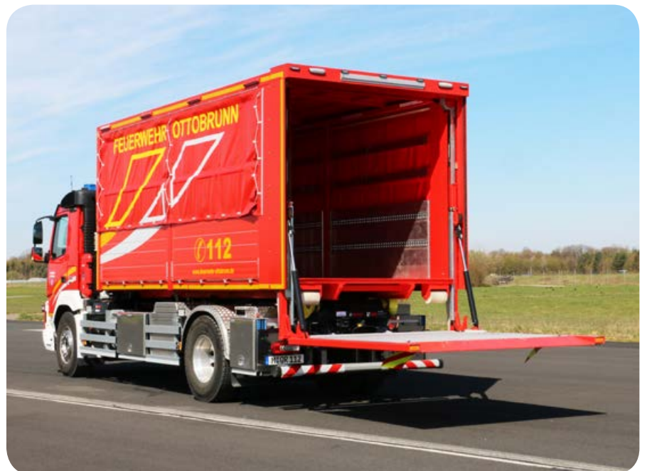
Mit dem 2000 kg hebenden Vertikallift lässt sich der Abrollbehälter-Rüstmaterial/Logistik be- und entladen ohne ihn absetzen zu müssen.
