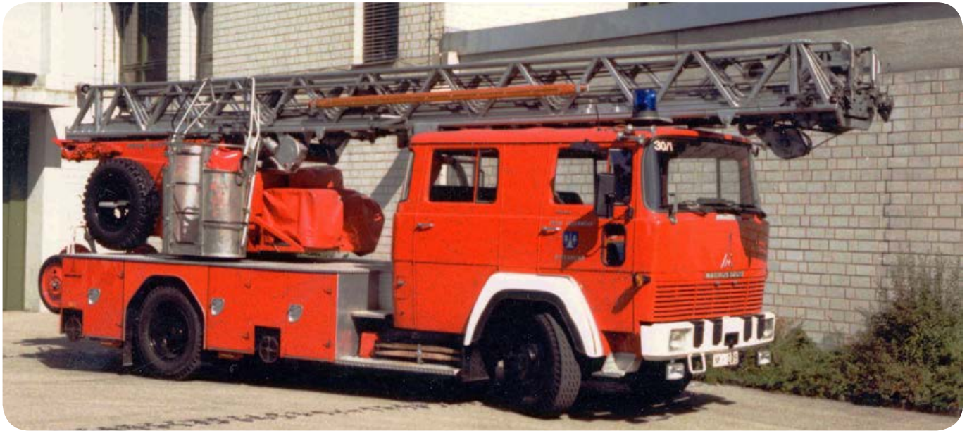
Vor 50 Jahren stellte die Ottobrunner Feuerwehr ihre erste Drehleiter in Dienst. Ausgefahren reicht ihr 30 Meter langer Leiterpark bis in den 8. Stock.
