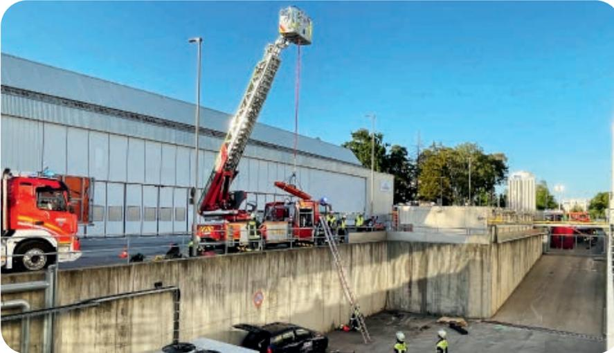
Die Übungssituation sagt, dass ein Auto in einem Graben gelandet ist. Zur schonenden Rettung des Fahrers kommt die Drehleiter mit der Schleifkorbtrage zum Einsatz.
