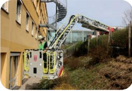
Mit einer Drehleiter kann man nicht nur 30 Meter in die Höhe fahren, sondern auch aus einem Graben retten.
