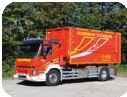
Wechsellader von 2021 mit Abrollbehälter Rüst/Logistik.
