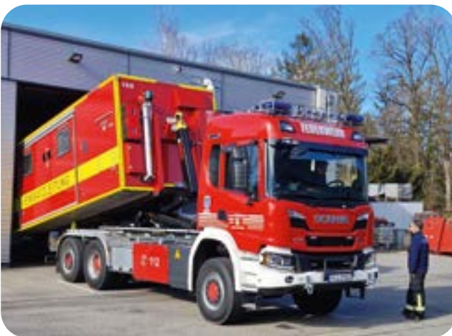
Der in der Wechselcontainerhalle abgestellte Aufbau wird mit dem hydraulischen Hakenarm auf das Trägerfahrzeug aufgezogen.
