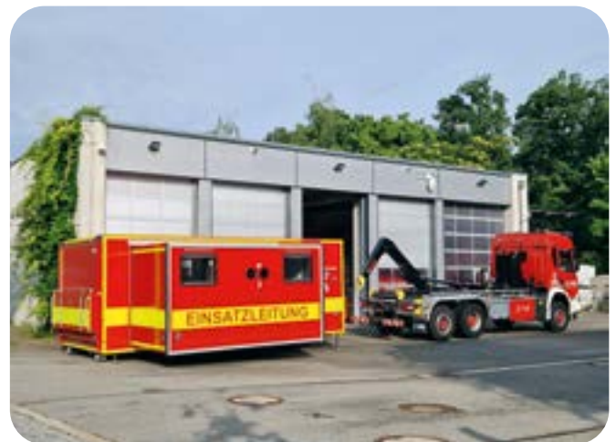
Links steht der abgesetzte Wechselaufbau, rechts davon das Trägerfahrzeug mit dem ausgeschwenkten Hakenarm.
